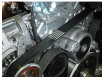
自動車のエアコン、オルタネータなど、多数の軸を1本で回す“自動車用Vリブドベルト”
