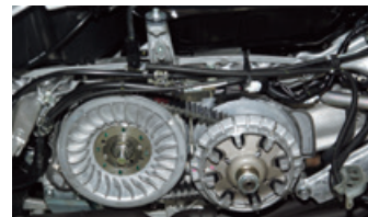
大型バイク等にも採用される、音が静かで変速がスムーズな“自動二輪車用変速ベルト”
