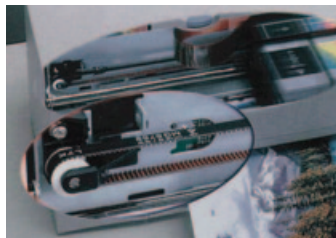
プリンタなどの位置決め精度、印字精度を要求される用途で使用されるOA機器プリンタキャリッジ用ベルト
